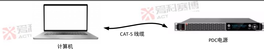
图 72 直接连接示意图
