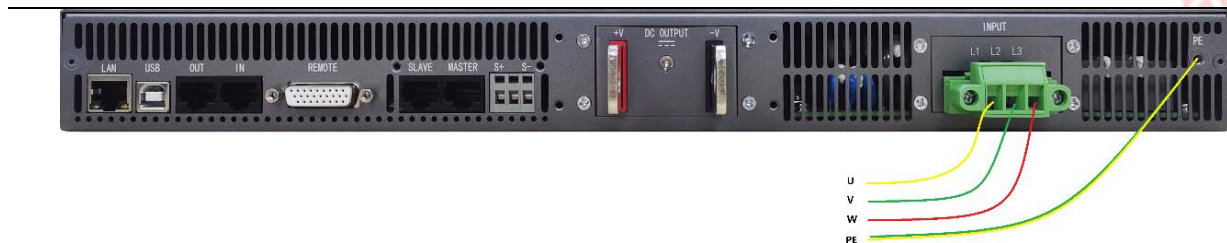
图 10 输入接线示意图
